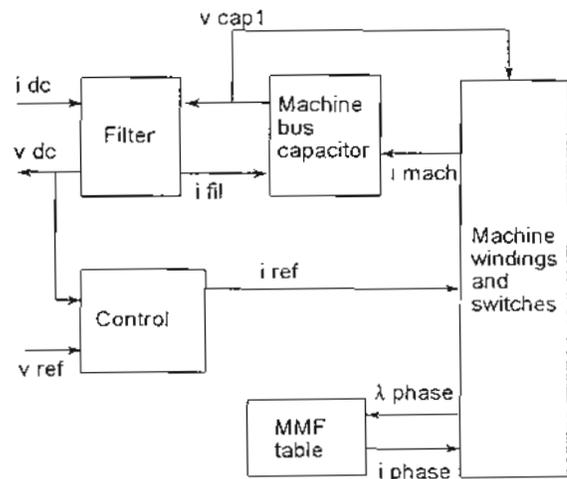
FIGURE 4: BLOCK DIAGRAM OF MACHINE SIMULATION
